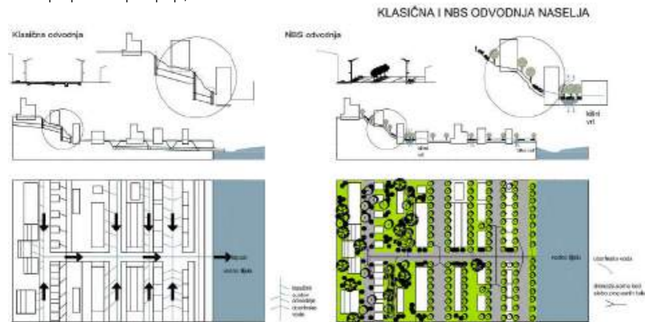
Slika 73 Klasični i NBS sustav odvodnje (autorski grafički prikaz)
